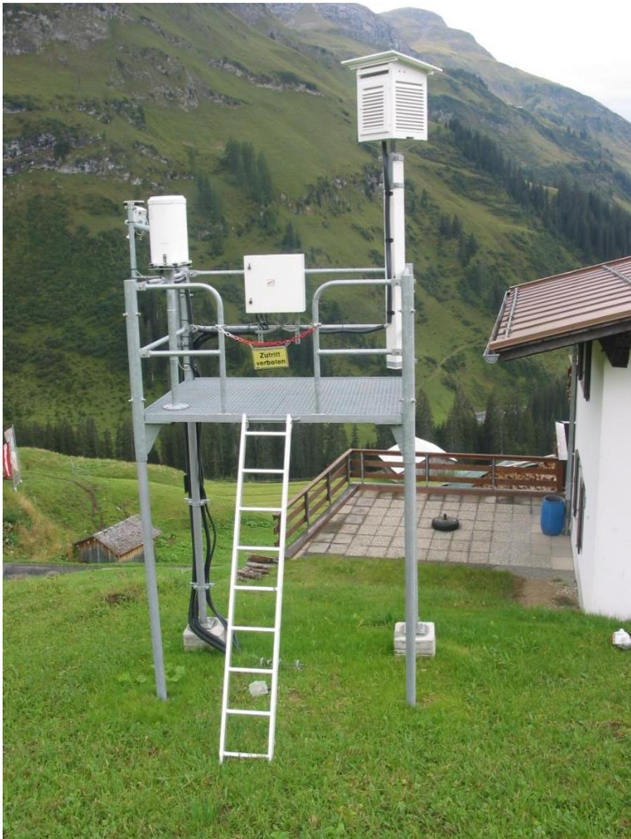
Abb. 3: Die hydrometeorologische Station der GeoSphere Austria in Warth. Das Schneemessfeld befindet sich unterhalb der Station auf der ebenen Fläche im Vorfeld der Terrasse. Foto: GeoSphere Austria.
